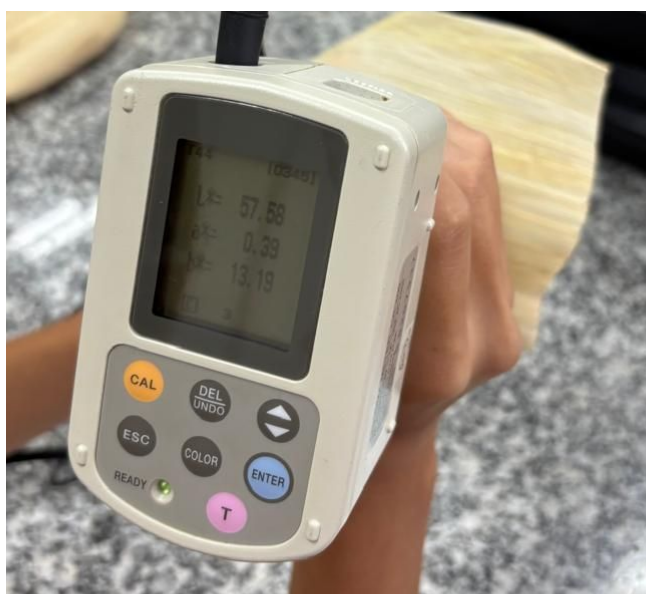
Figura 3 – Avaliação da coloração da palha de milho utilizando colorímetro, Sete Lagoas, MG, 2026.
