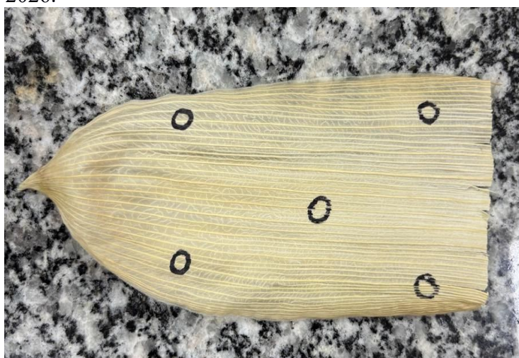
Figura 5 – Pontos de medição utilizados para determinação da espessura da palha de milho, Sete Lagoas, MG, 2026.
