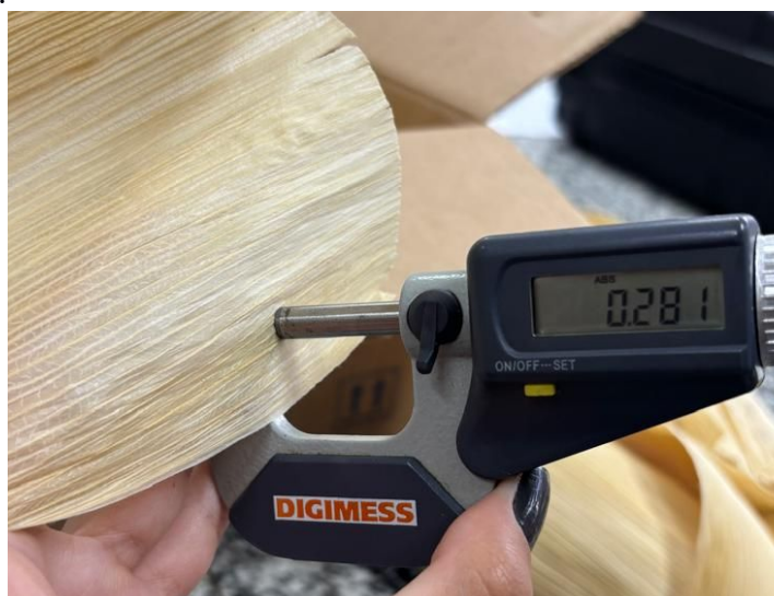
Figura 4 – Determinação da espessura da palha de milho utilizando micrômetro digital, Sete Lagoas, MG, 2026.
